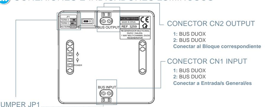
La borna INPUT se debe conectar a la sección de la instalación correspondiente a las entradas generales y la borna OUTPUT al bloque correspondiente (1 regenerador multicanal por bloque). La borna INPUT posee una adaptación de línea incorporada (configurable mediante JP1), para aprovechar dicha terminación en función de la topología de la instalación.
