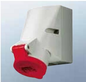
⚠ IP 44 Wandsteckdose, Befestigung von innen, Leitungseinführungen einmal oben und einmal blind (zum Ausschneiden) unten, Gehäuseunterteil um 180° drehbar
