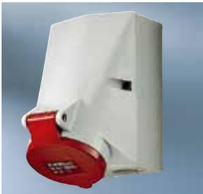
⚠ IP 44 Wandsteckdose, Befestigung von innen, Leitungseinführungen einmal oben und zweimal blind (zum Ausschneiden) unten, Gehäuseunterteil um 180° drehbar
