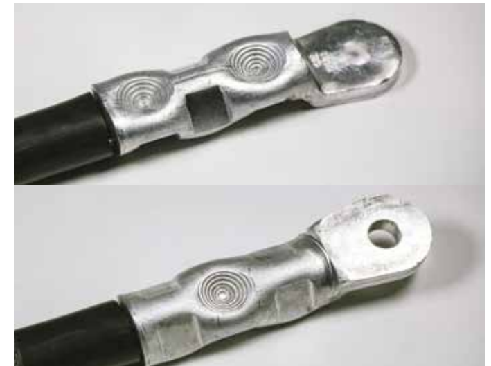
Bild 8: Dornpressung von oben und unten
