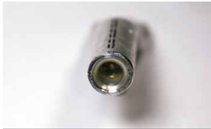
Bild 7: Aluminium Kabelschuh mit Plastikkappe
