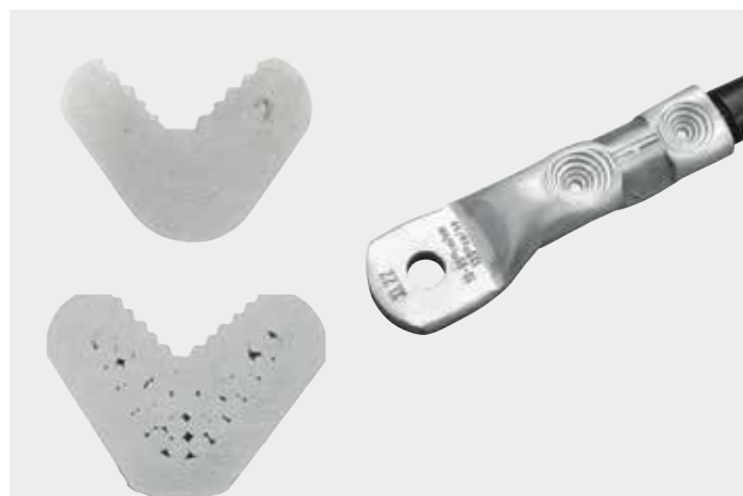
Bild 7: Schliffbild Aluminium Klasse 1, 2 und verpresster Kabelschuh Al-Serie (Dornpressung)
