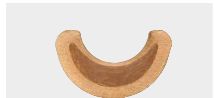
Bild 11: Schliffbild Dornpressung Klasse 6 Leiter im F-Kabelschuh
