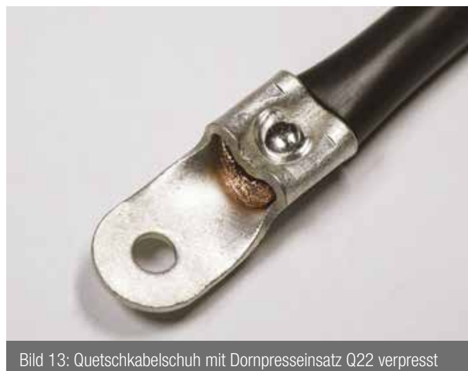
Bild 12: Quetschkabelschuh mit Dornpressung verpresst
