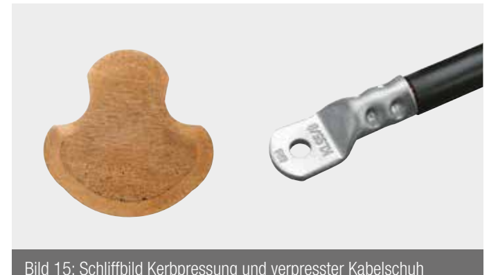
Bild 15: Schliffbild Kerbpressung und verpresster Kabelschuh
