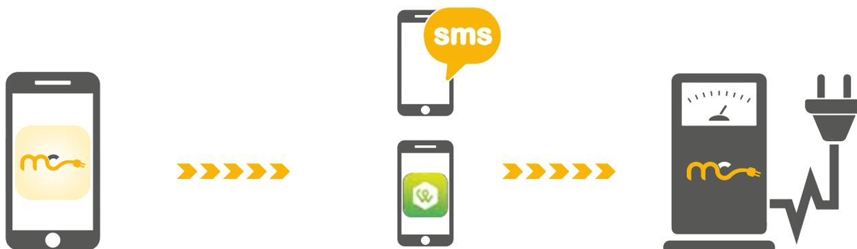
Der User installiert mobilecharge auf seinem Smartphone und erhält eine RFID-Karte.
