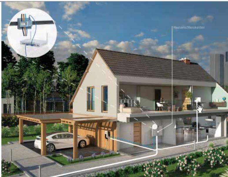
L'interconnexion entre le compteur électrique et la borne de recharge peut se faire par une connexion directe ou par un commutateur Ethernet. La borne de recharge est compatible avec les compteurs électriques suivants : dispositif de mesure de puissance standard LCD / 3P / 5A.
