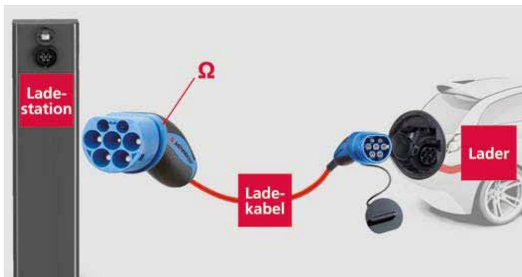
Das schwächste Glied der Ladekette bestimmt den maximal zulässigen Ladestrom: Abhängig von der Leistung der Ladestation und der Widerstandscodierung im Stecker des Ladekabels wird der Ladestrom im Lader begrenzt.
