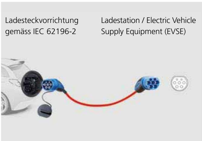
Modus für das Laden an Ladestationen mit einer speziellen Ladeeinrichtung gemäss IEC 61851, der sogenannten „EV Supply Equipment“, also der Ladeinfrastruktur. Das Ladegerät ist ein fester Bestandteil der Ladestation. In der Ladestation sind PWM-Kommunikation, FI-Schalter, Überstromschutz, Abschaltung sowie
