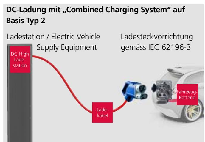
Modus für das Laden an DC-Gleichstrom-Ladestationen mit einer definierten Ladeeinrichtung gemäss IEC 61851, der sogenannten „Electrical Vehicle Supply Equipment“ (EVSE), also der Ladeinfrastruktur, mit fest installierter Steuer- und Schutzfunktion. Das Ladegerät ist Bestandteil der Ladestation. Im Mode 4 kann das Fahrzeug mit zwei Steckvorrichtungssystemen geladen werden, die beide auf der
