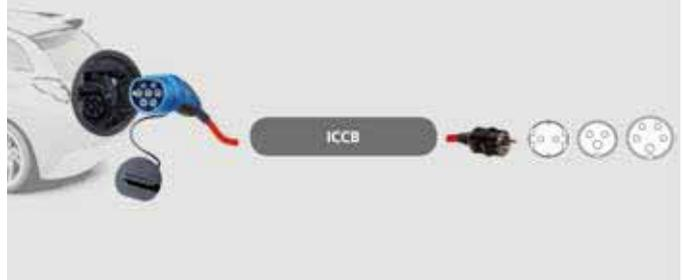
Modus für das Laden aus einer Steckdose bis max. 32 A dreiphasig mit einer in das Kabel oder den wandseitigen Stecker integrierten Steuer- und Schutzfunktion. Das Ladegerät ist im Fahrzeug eingebaut. Der Anschluss ans Energienetz erfolgt über eine handelsübliche genormte Steckvorrichtung.
